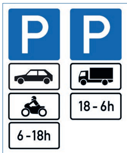
Abbildung 14: Hinweisschilder für die nächtliche Nutzung von Pkw-Parkplätzen durch Lkw 135
